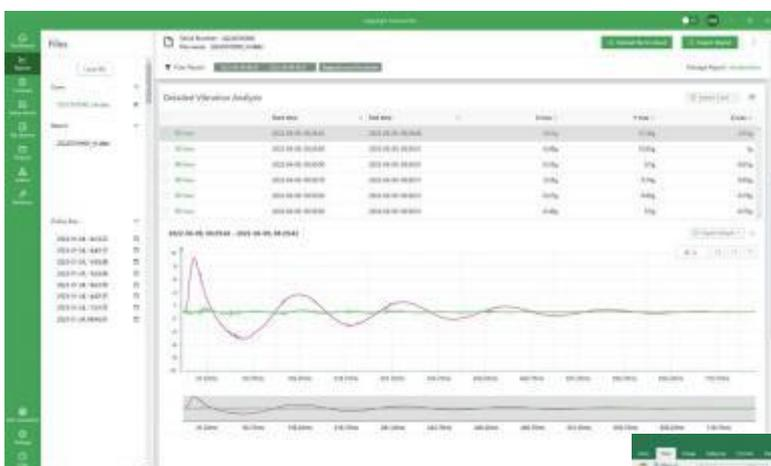
列出所有事件，一步一步研究每条冲击曲线。缩放冲击曲线以及更改曲线的显示，以查看所有细节。
