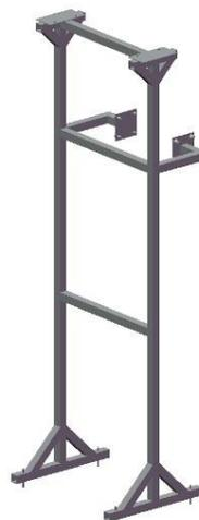
变压器安装式支架结构
