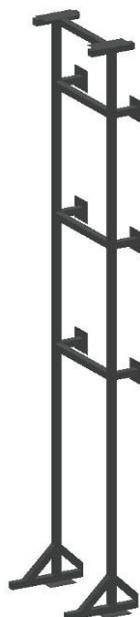
防火墙安装式支架结构
